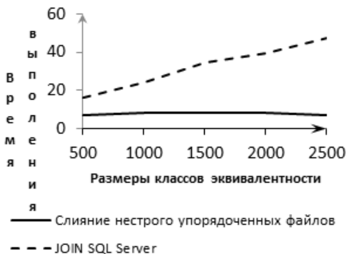
Рис. 5.12. Зависимость времени выполнения операции слияния нестрого упорядоченных файлов от размеров классов эквивалентности
