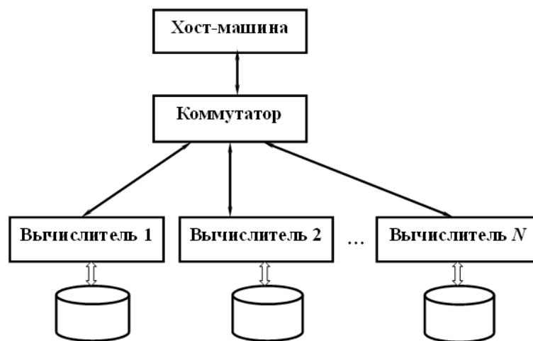
Рис. 5.3. Архитектура вычислительной системы для реализации теоретико-множественной модели
