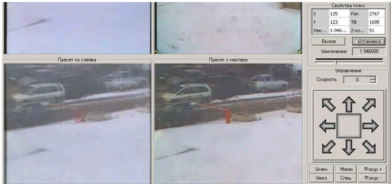
Рисунок 7.8. Смещение изображений слейва и мастера из-за погрешности наведения (изображение шлагбаума в центре левого изображения раздвоено).
