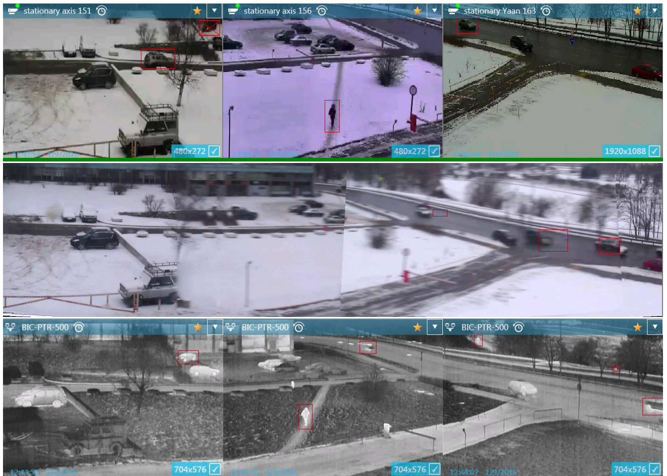
Рисунок 7.4. Поля зрения камер: сверху для неподвижных в первой системе, в центре для панорамной камеры (в виде панорамы), снизу для тепловизионной камеры в трёх положениях шагового режима.
