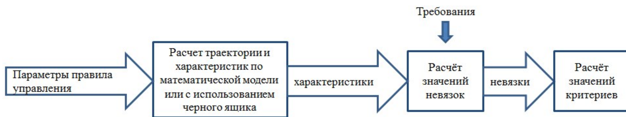
Рис. 0.0.1 Блок-схема расчета критериев задачи МКО для динамической системы
