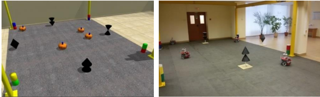
Рис. 5.7. а) Модель полигона в системе Gazebo , б) реальный полигон
