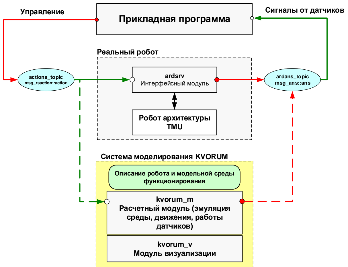
Рис. 5.9. Концептуальная схема системы моделирования KVORUM
