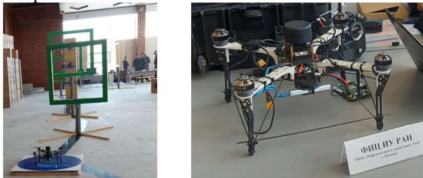
Рис.6. Пример среды полета квадрокоптера со смешанными фазовыми ограничениями
