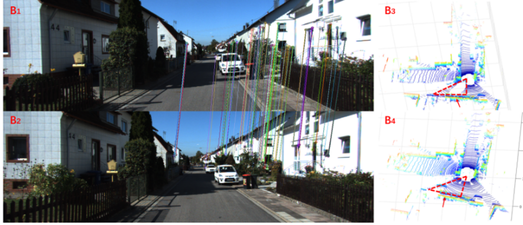
Рисунок 1.12 — Взаимное дополнение информации, содержащейся в облаках точек и в изображениях. Источник [68].
