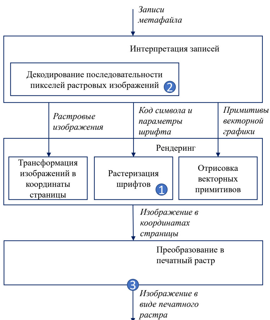
Рисунок 6 – Схема работы RIP с указанием модулей для передачи управления в специальные режимы печати.
