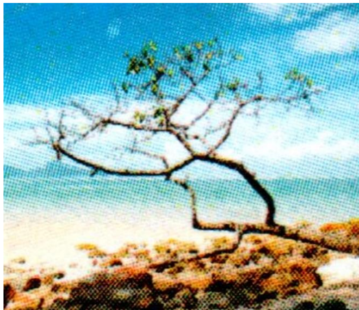
Рисунок 1.1 – Печатный растр на изображении, напечатанном на цветном лазерном принтере
