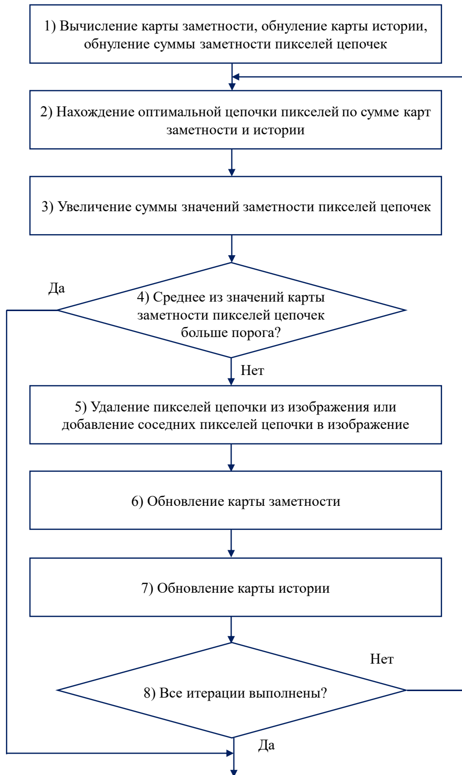
Рисунок 6.4 – Схема предлагаемого способа переформатирования изображений.
