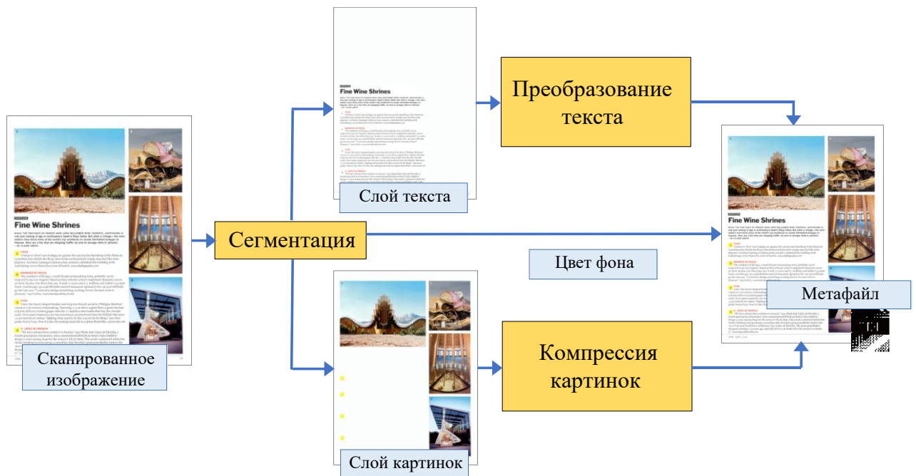
Рисунок 1.4 – Схема обработки при использовании концепции модели смешанного растрового содержимого.
