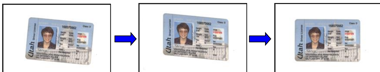
Рисунок 3.6 – Пример поворота изображения с помощью сдвига по строкам, затем по столбцам.
