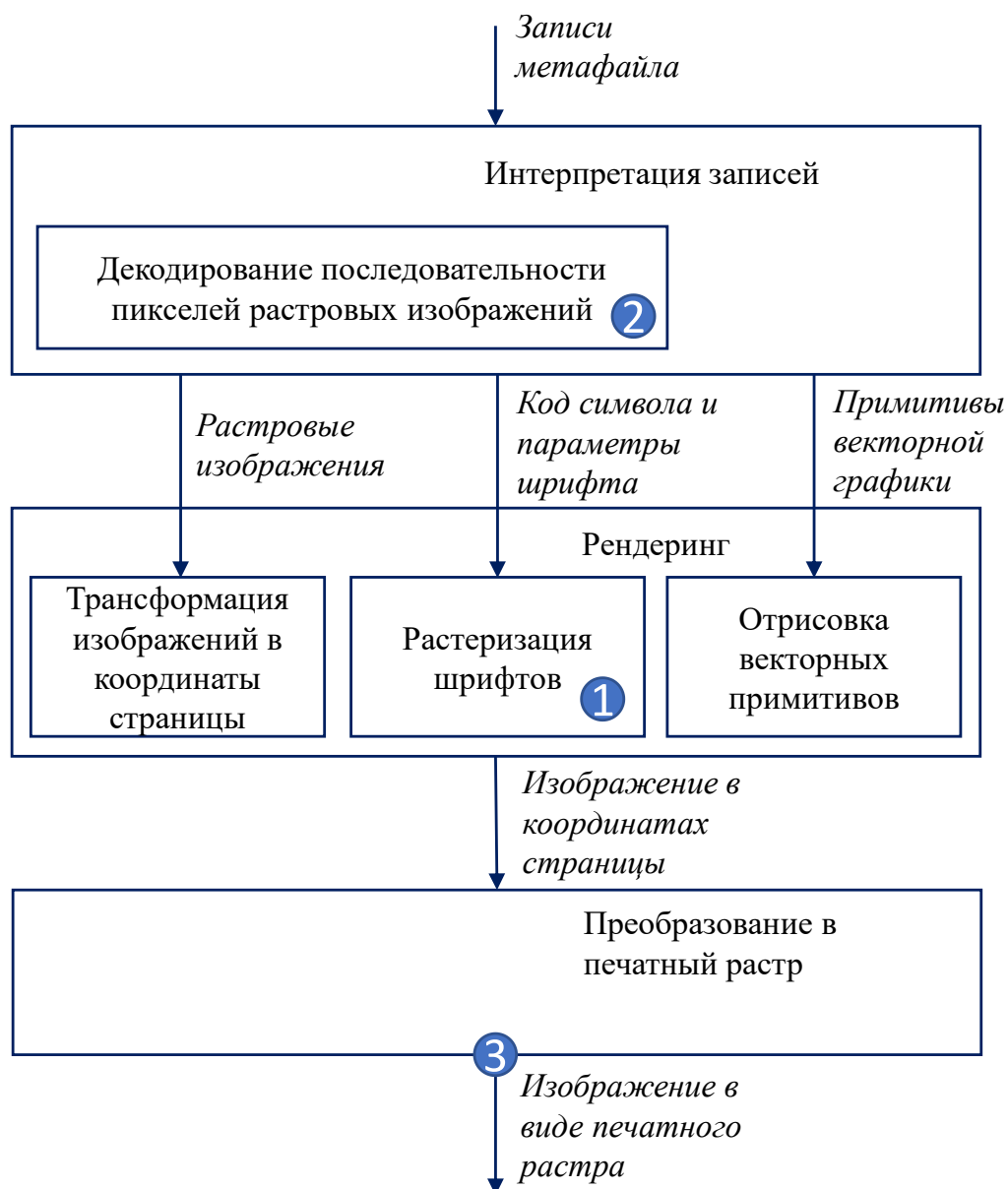
Рисунок 4.3 – Схема работы RIP с указанием модулей для передачи управления в специальные режимы печати.
