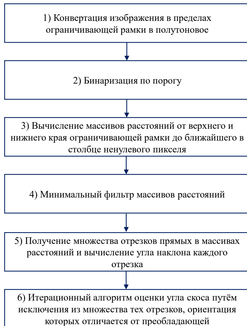
Рисунок 3.4 – Схема способа оценки угла скоса.
