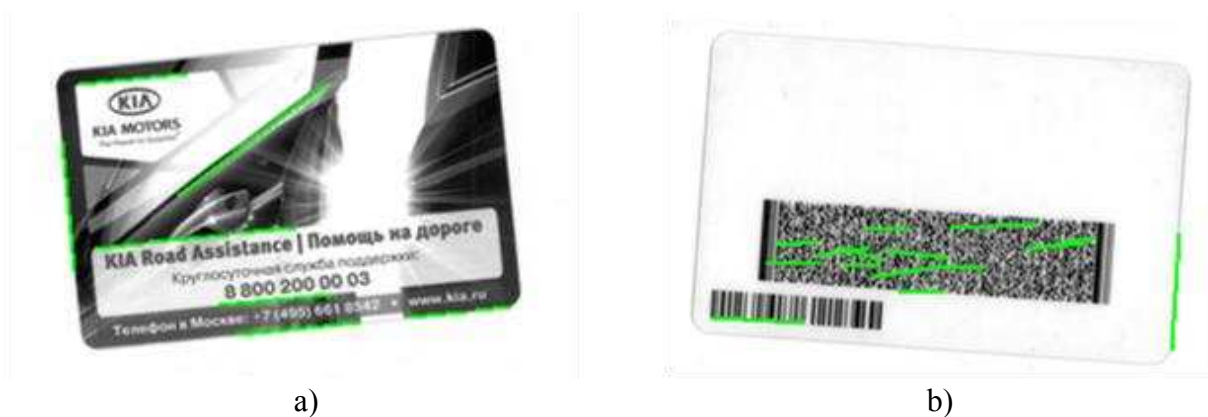
Рисунок 3.3 – Примеры детектирования отрезков прямых с помощью преобразования Хафа; а) лицевая сторона карточки; б) обратная сторона карточки.
