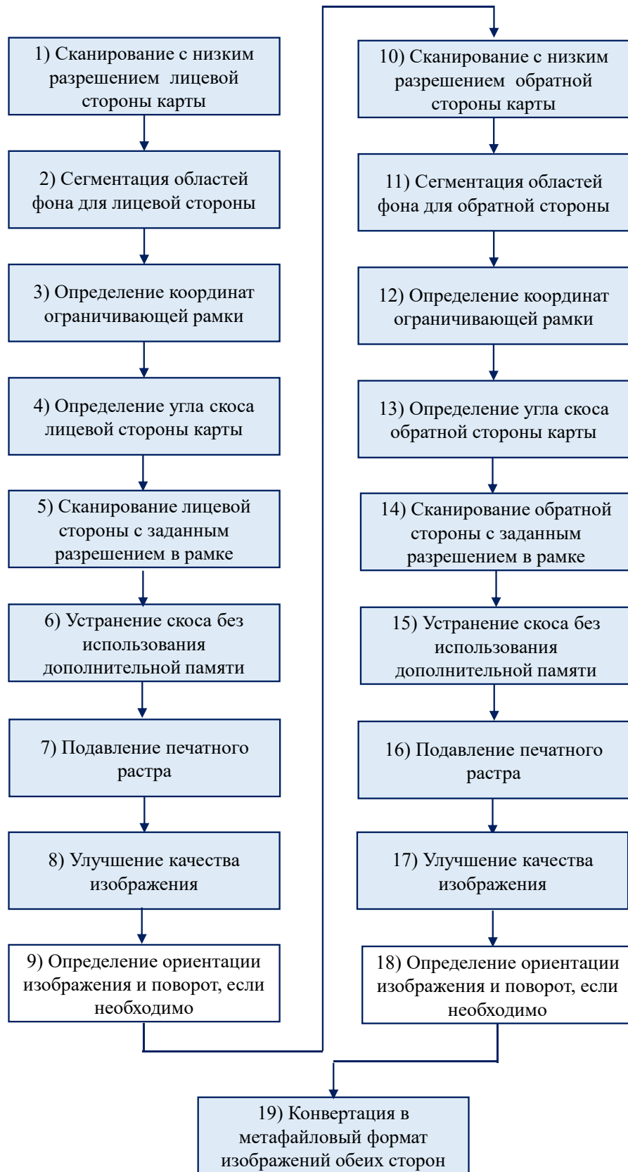
Рисунок 3.28 – Схема этапов обработки в режиме копирования двухсторонних карточек.
